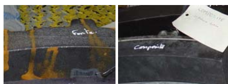
Des semelles de frein en fonte (à gauche) et en matériau composite (à droite)
